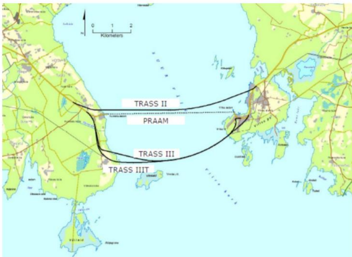
Joonis 1. 2011. aastal koostatud „Sõitjate ja veoste üle Suure väina veo perspektiivse korraldamise kavas“ esitatud Suure väina püsiühenduse alternatiivid. Trass II ja trass III tähistavad silla ja trass III T tunneli trassialternatiivi. Punktiiriga on tähistatud olemasolev parvlaevaiühendus.
